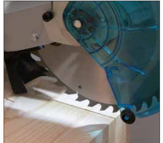
Đèn LED có chức năng dẫn hướng đường cắt
