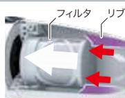
カプセル内部のリップがフィルタをしっかり押さえる。
